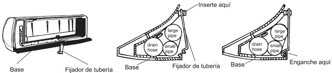
A. Inserte el fijador de tubería en la ranura.
