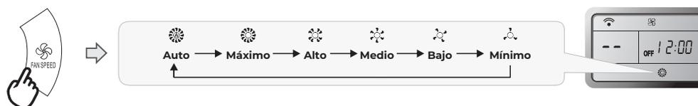
! En el modo de "VENTILADOR SOLO", solo están disponibles las velocidades "Alto", "Medio" y "Bajo" . En modo "DRY", la velocidad del ventilador es ajustada a "AUTO" automáticamente. El botón "FAN SPEED" es inválido en este caso.
